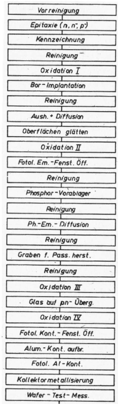
Abb. 3.3.2. Arbeitsgangfolge (grob) zur Herstellung eines Transistors-in Mehrschritt-Epitaxie-Technologie (MET)
