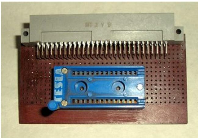
Die Zuordnung der Anschluss-Pins der Schwenkhebelfassung ist in den Kreisnummierungen angegeben. Dabei ist zu beachten, daß die Anschlußnummerierung der Schwenkhebelfassung nicht in jedem Fall identisch mit der Nummerierung der Anschluß-Pins des jeweiligen EPROM's ist, z.B. hat ein 2716 den Masse-Anschluß am Pin 12!
