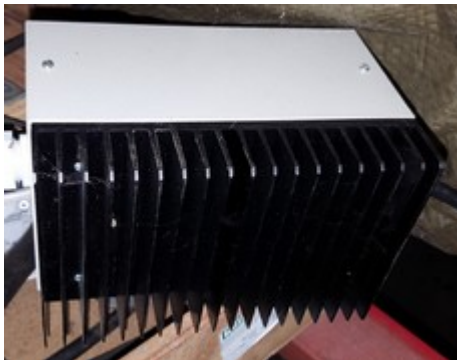
Bild 9-1: 10A-Graetzgleichrichter-Brücke mit Kühlkörper
