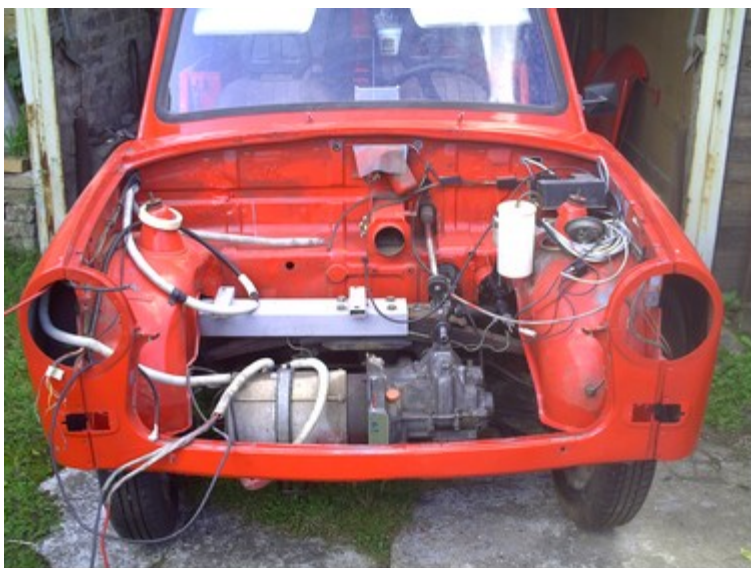
Bild 5: Motorraum ohne Batteriekasten, Motorsteuerung ausgebaut
