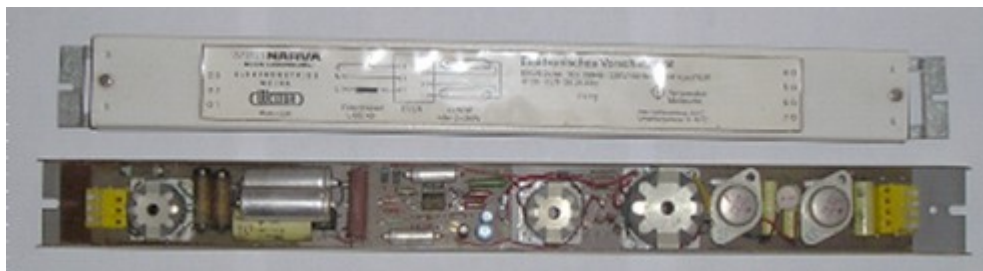
Bild 13: Elektronisches Vorschaltgerät EVLN 2x40 Hersteller VEB Elektrobetrieb Weida WELTOR im VEB Kombinat NARVA „Rosa Luxemburg“
