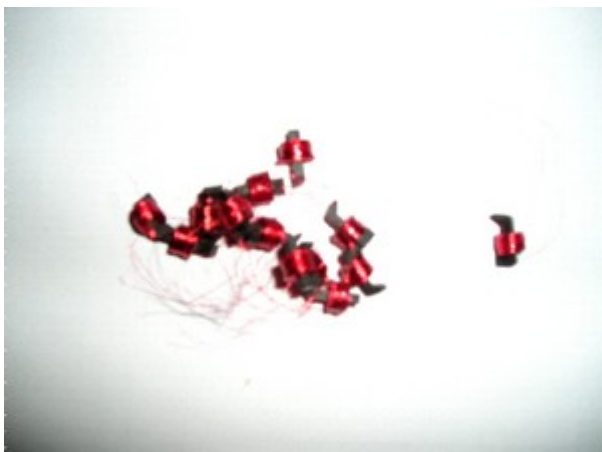
Bild 3: Bewickelte Miniatur-Ferritkerne (10mm x 3,5mm)
