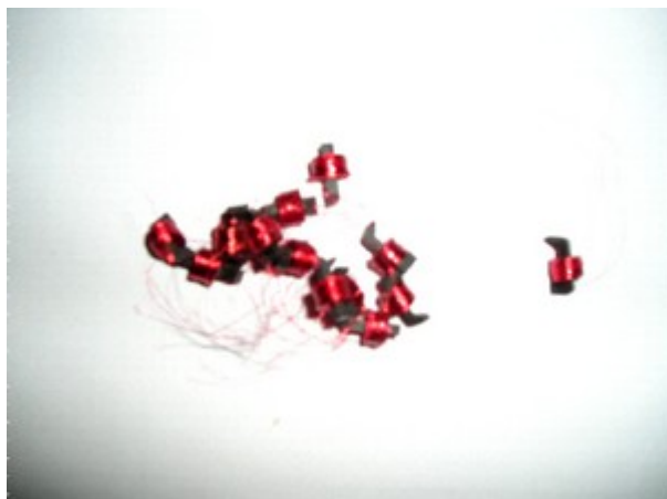
Bild 3: Bewickelte Miniatur-Ferritkerne (10mm x 3,5mm)
